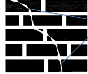
Hasar görmüş yapıda tamir harcı olarak kullanım alanı
